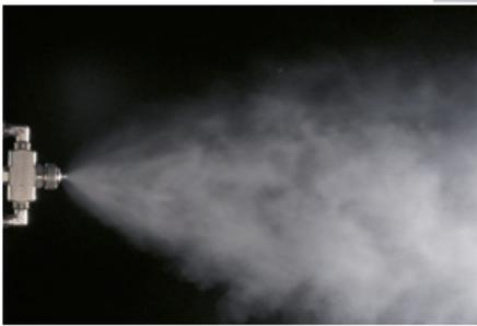
*Feinstzerstäubung mittels Druckluft
