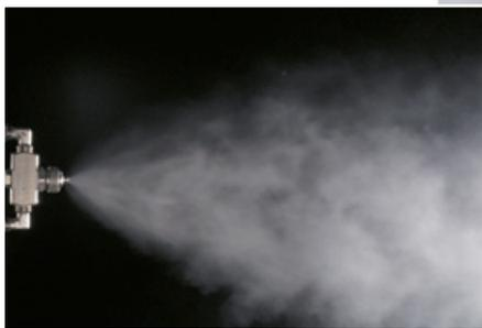
*Feinstzerstäubung mittels Druckluft
