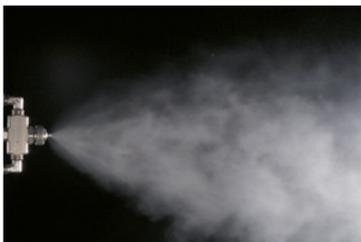
*Feinstzerstäubung mittels Druckluft
