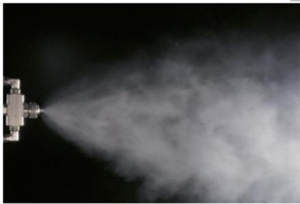
*Feinstzerstäubung mittels Druckluft
