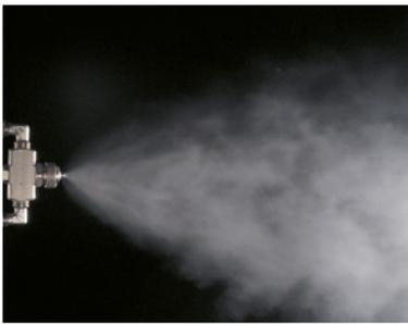
*Feinstzerstäubung mittels Druckluft*
